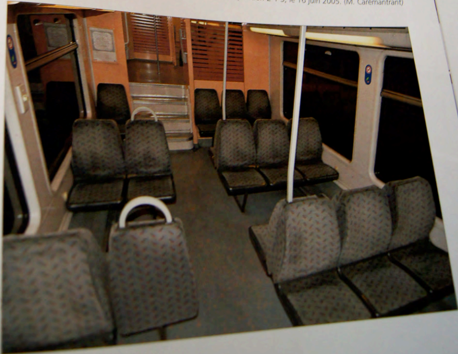
de ce type sur un programme de seize, selon le modèle d'automotrice Z 5323 correspondant à la 1 re rame rénovée Automotrice Z 6400 rénovée soit, aménagement monoclasse, sièges individuels, nouveaux coloris, disposition 2 + 3, le 16 juin 2005. (M. Carémantrand)
